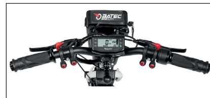
Manillar de aluminio negro mate con sistema de plegado para transporte.
