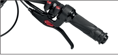
Frenos mecánicos doble pinza, sensor con corte de corriente. Manetas aluminio con freno y corte de encendido. Disco Rotor 180mm.
